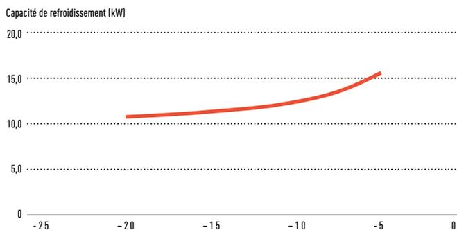
Température ambiante : 32 °C, 400 V, compresseur : fréquence de fonctionnement : 60 S<sup>-1</sup>, Réfrigérant: R744, température du gaz d'aspiration : 18 °C
