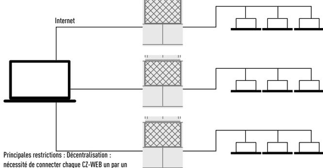
Principales restrictions : Décentralisation : nécessité de connecter chaque CZ-WEB un par un pour gérer l'installation.
