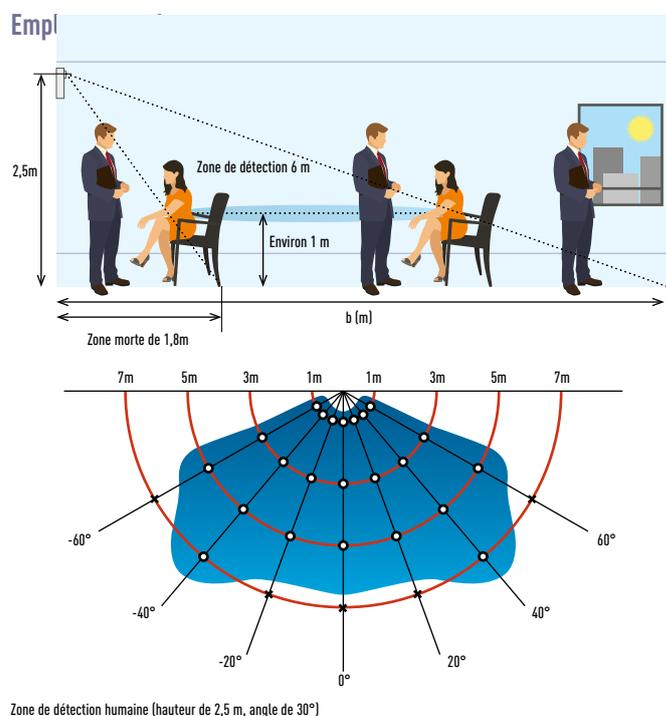
En fournissant des économies d'énergie exceptionnelles, le système Inverter Panasonic peut être raccordé à Econavi pour détecter toute déperdition d'énergie. Econavi détecte la présence ou l'absence de personnes dans la pièce et le niveau d'activité dans chaque zone d'un bureau. Lorsqu'un chauffage ou un refroidissement inutile est détecté, les unités intérieures sont contrôlées individuellement pour s'adapter aux conditions du bureau afin d'économiser l'énergie.
