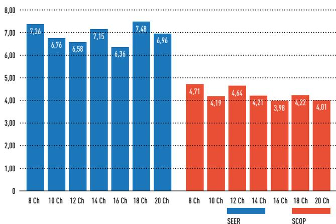
Cependant, si cela s'avérait nécessaire à la mise en service, Panasonic peut augmenter l'efficacité de 20% supplémentaires en augmentant la plage de température d'évaporation du réfrigérant, pour obtenir une meilleure efficacité énergétique et une moindre consommation d'énergie.
