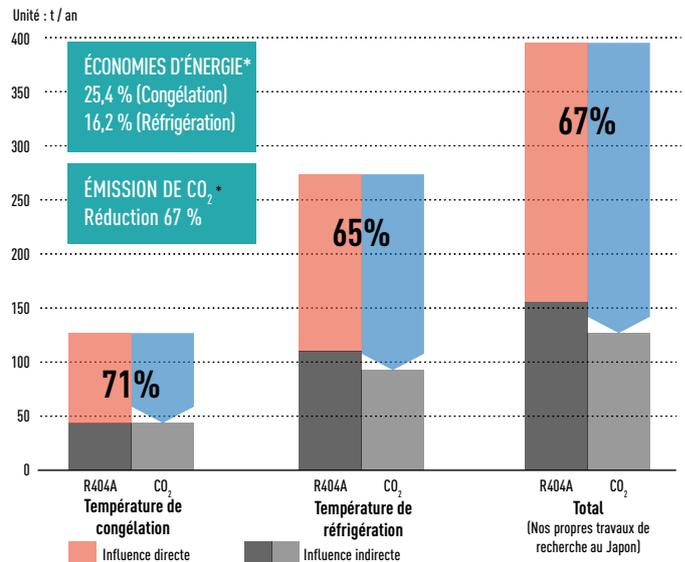
\* Étude Panasonic réalisée auprès de 6 magasins au Japon Comparatif : 6 magasins et données moyennes d'une unité de condensation Inverter multi R404A Facteur de conversion CO<sub>2</sub> électricité : 0.000579 t - CO<sub>2</sub> / kWh. Taux de fuite de réfrigérant 16%
