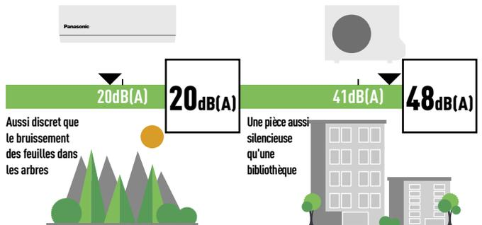
KIT-BE25-TKE et KIT-BE35-TKE : en mode silencieux alors que l'appareil fonctionne en mode rafraîchissement avec une faible vitesse de ventilateur.
