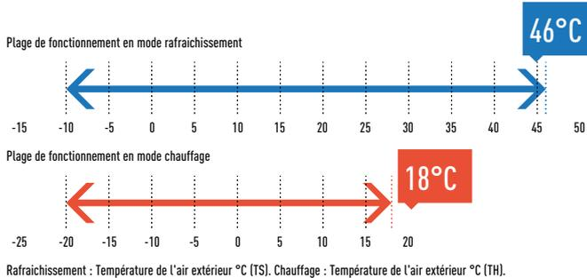
La fonction de chauffage reste stable, même lorsque la température extérieure chute à -20°C. La plage de fonctionnement en mode chaud a été étendue à -20°C grâce à l'utilisation d'un compresseur avec une enveloppe haute pression.
