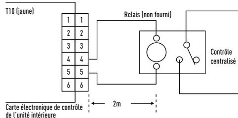
NOTE : La longueur du câble entre l'unité intérieure et le relais doit être au maximum de 2,0m. Signal d'impulsion modifiable en statique avec le JP cutting. (Reportez-vous à JP001).
