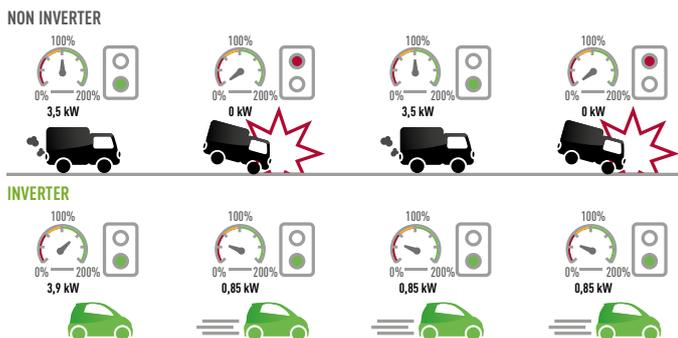
**NON INVERTER.** Lent à démarrer. Il faut plus longtemps pour atteindre la température de consigne. La température oscille entre les deux extrêmes et ne réussit jamais à se stabiliser. La température chute puis augmente brutalement, ce qui engendre un pic de consommation.
