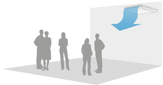
La diffusion de l'air est automatiquement modifiée en fonction du mode de fonctionnement
