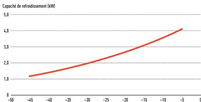
Température ambiante : 32°C, 200V, Compresseur : fréquence de fonctionnement : 65 S<sup>-1</sup>, Réfrigérant: R744, température du gaz d'aspiration : 18 °C
