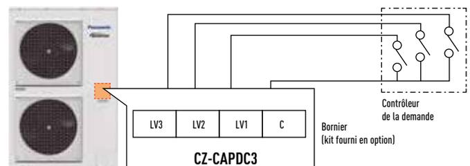
Le terminal de contrôle de la demande est disponible pour contrôler 0-50-75% des capacités. CZ-CAPDC3 est une option pour les modèles au R410A.
