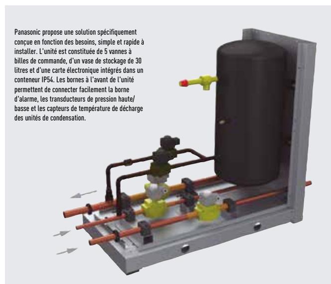
Panasonic propose une solution spécifiquement conçue en fonction des besoins, simple et rapide à installer. L'unité est constituée de 5 vannes à billes de commande, d'un vase de stockage de 30 litres et d'une carte électronique intégrés dans un conteneur IP54. Les bornes à l'avant de l'unité permettent de connecter facilement la borne d'alarme, les transducteurs de pression haute/basse et les capteurs de température de décharge des unités de condensation.
