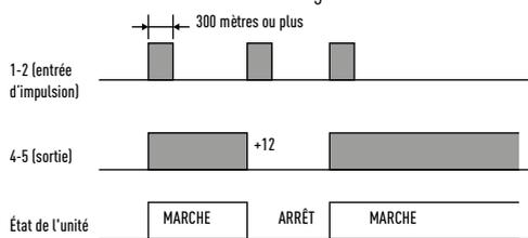
NOTE : la longueur du câble entre l'unité intérieure et le relais doit être au maximum de 2,0m. Signal d'impulsion modifiable en statique avec le JP cutting. (Reportez-vous à JP001).
