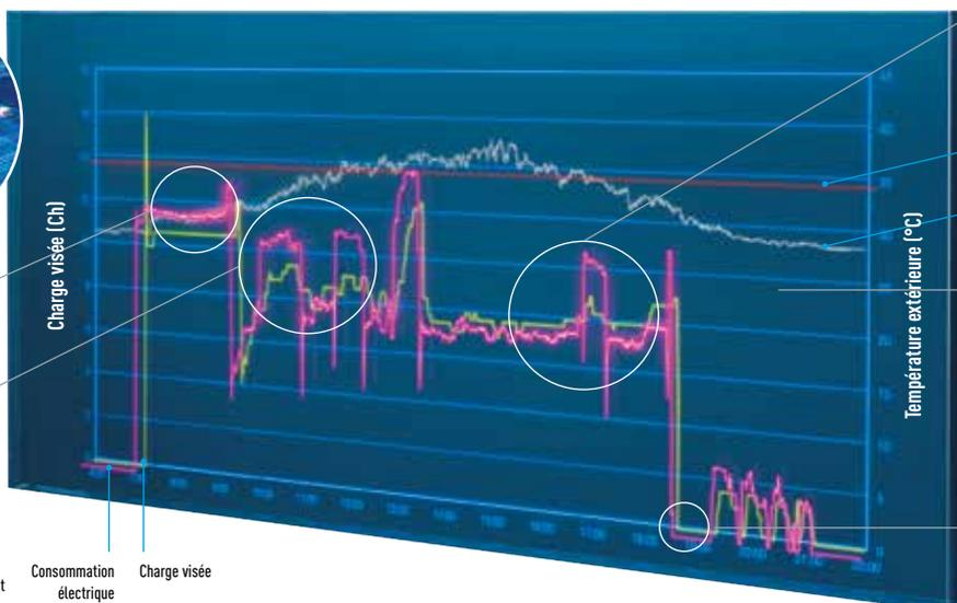
Température de consigne maintenue avec fonctionnement à charge minimale
