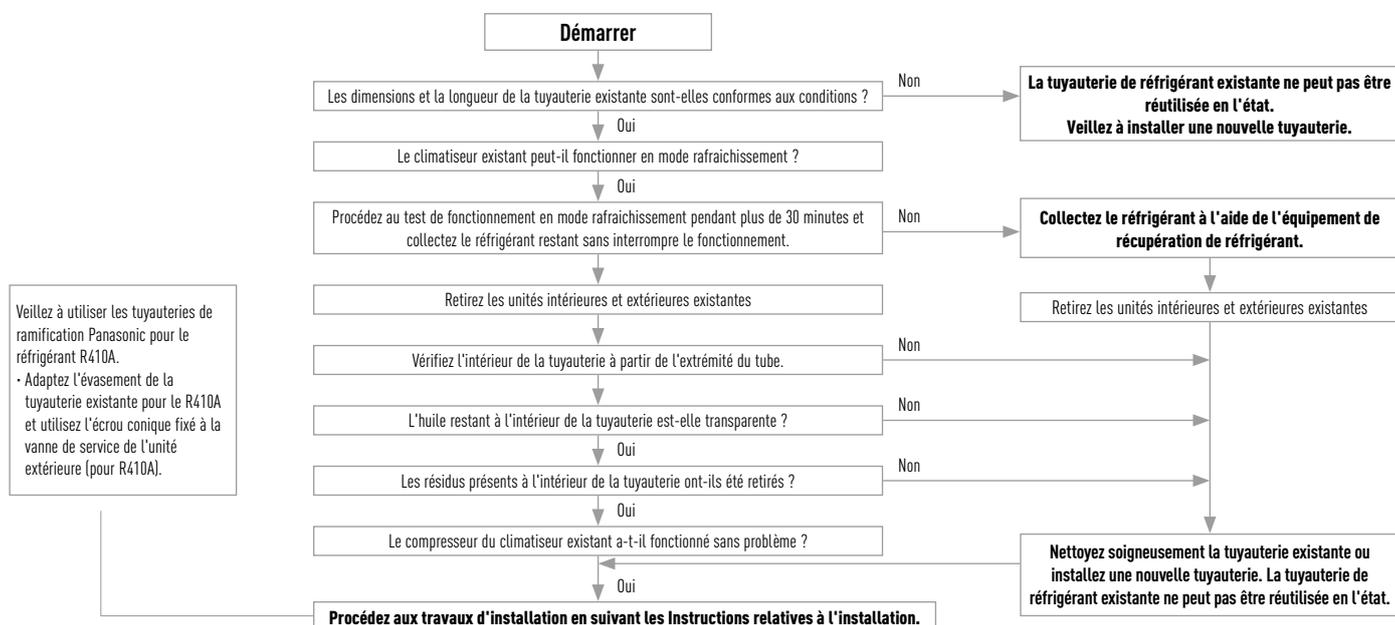
Conditions préalables : • si un réfrigérant autre que le R22, le R407C ou le R410A est utilisé dans l'unité existante, la tuyauterie ne peut pas être réutilisée. • Si l'unité existante est utilisée à d'autres fins que la climatisation de l'air, la tuyauterie de réfrigérant existante ne peut pas être utilisée.
