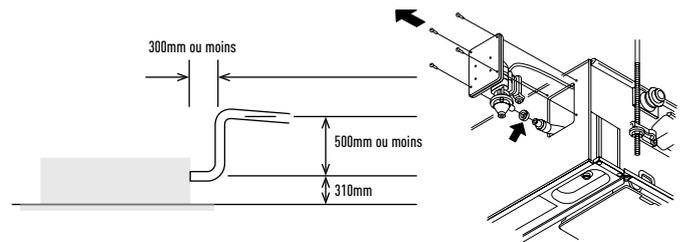
L'entretien de la pompe à condensat est possible de deux côtés, du côté gauche (côté tuyauterie) et depuis l'intérieur de l'unité.
