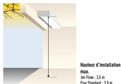
Un rideau d'air haute efficacité connecté à votre installation DRV. Moteur de ventilateur EC pour un fonctionnement discret et une grande efficacité. 2 types de débit d'air disponibles : Jet-Flow et Standard. Nettoyage et entretien faciles.
